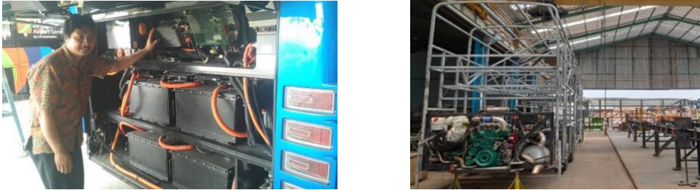
Gambar prototipe baterai dan rangka dari full-electric bus yang sedang dikembangkan
